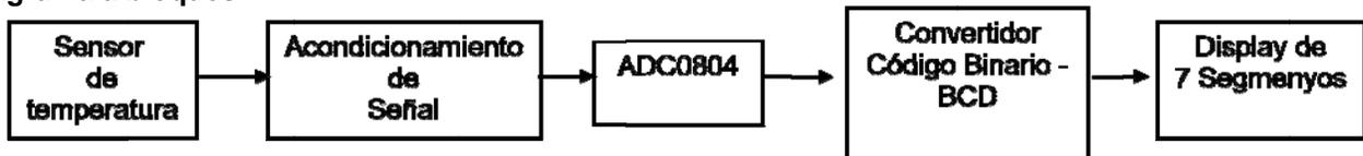
Figura 1) Diagrama a bloques del termómetro digital.
